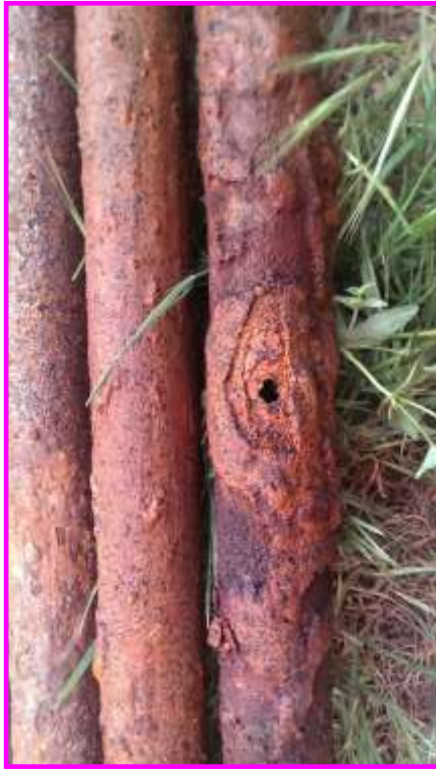
شكل (6-21) تآكل أنابيب رفع المياه من البئر إلى السطح بسبب ملوحة المياه العالية
